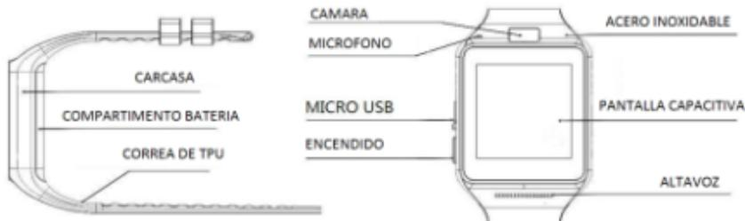
**Botón de encendido:** Encendido / apagado reloj, apagado/encendido de la pantalla; Volver al menú principal
